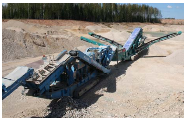
Joonis 16. Näited karjääris töötavast mobiilsest purustus-sorteerimissõlmest. Ain Põldvere fotod.
