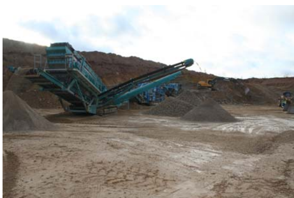
Joonis 16. Näited karjääris töötavast mobiilsest purustus-sorteerimissõlmest. Ain Põldvere fotod.
